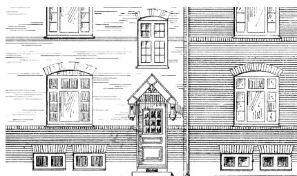
Eksempel på yderdør med baldakin fra det oprindelige tegningsmateriale
