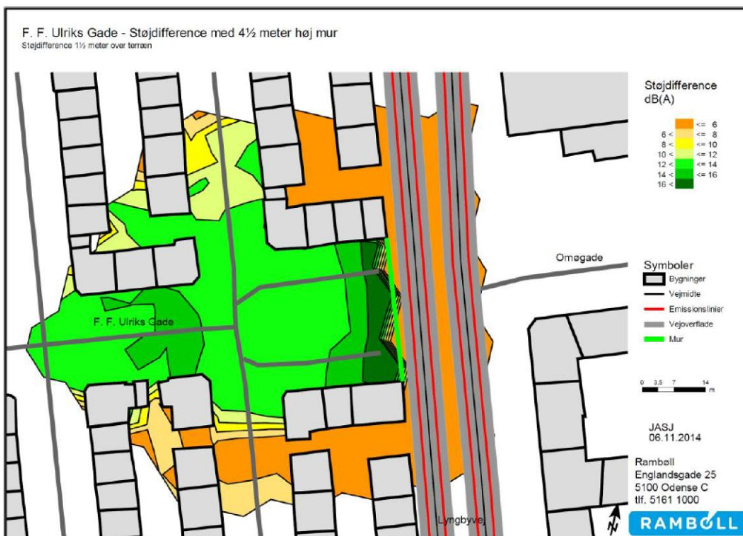
Figur 5. Opnået støjdæmpning med 4,5 meter mur. Kortet viser, at støjen på arealet mellem H. P. Ørums Gade og Lyngbyvej reduceres med 12 – 16 dB.
